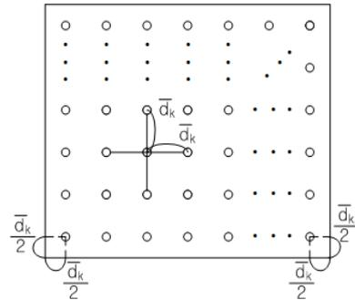
그림 4. 전체영역에서의 센서 초기 배치도 예
