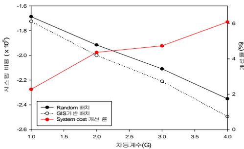
그림 8. G변화에 따른 초기 시스템 비용(n=1)
