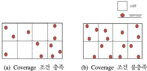
그림 2. 센서 배치에 따른 Coverage 조건의 가부
